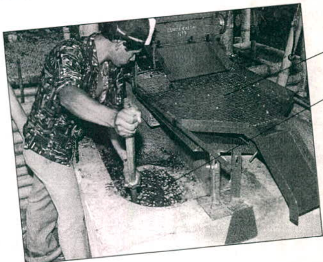
Figura 24. Lavado del café por agitación manual en el tanque tina. La zaranda plana clasifica el café despulpado.
