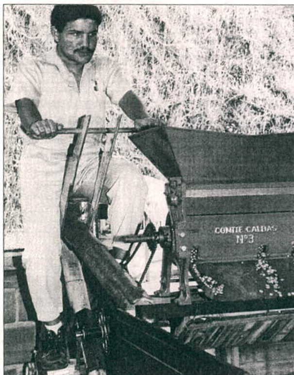
Figura 18. Despulpadora Nº 3 (tradicionalmente accionada por un motor de 1 hp) movida a pedal.
