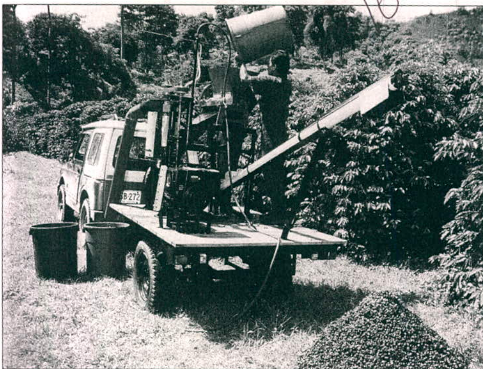
Figura 68. Módulo BECOLSUB 600 móvil, remolcado por un vehículo campero.
