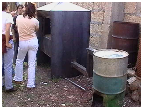
Figura 3. Horno utilizado en Tenerife, Islas Canarias, para ahumar quesos, utilizando cladodios de nopal.
