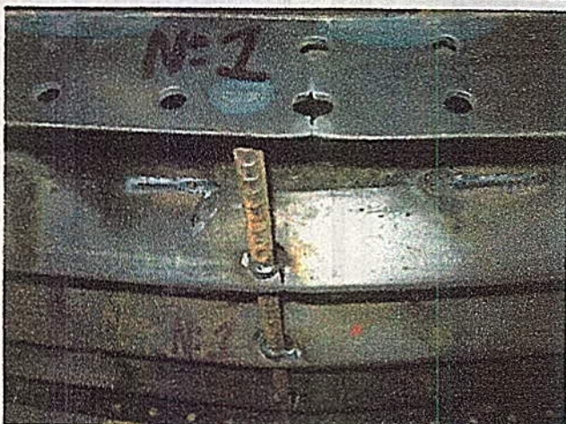
Foto No. 3 y 4 Falla de la formaleta No. 1, en la zona de rigidizadores longitudinales se reventó la soldadura y se agrandaron los agujeros
