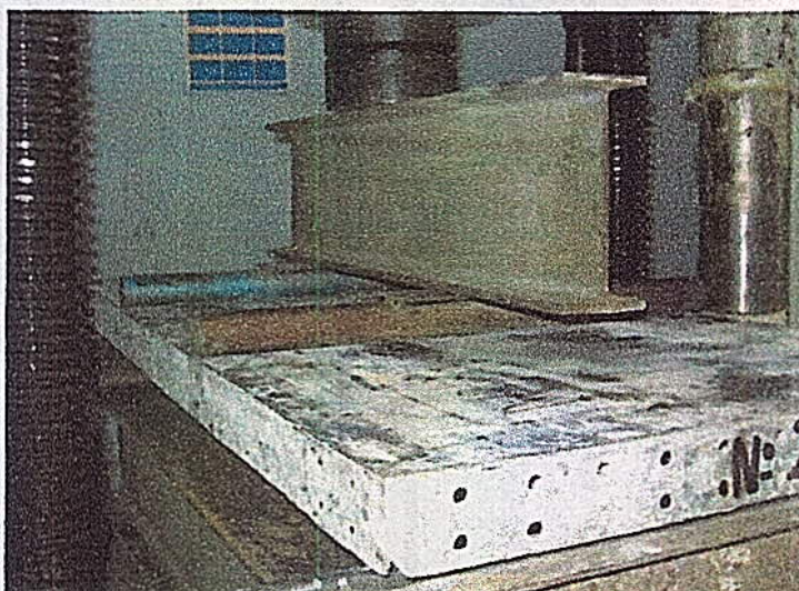
Foto No. 1 Esquema de montaje Carga simétrica en zona cercana a los tercios
