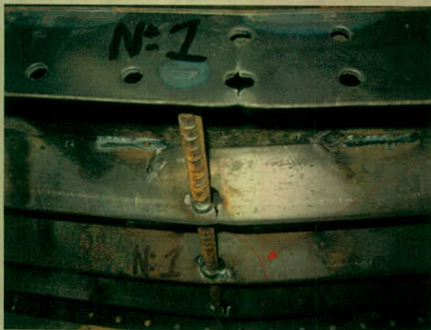
Foto No. 3 y 4 Falla de la formaleta No. 1, en la zona de rigidizadores longitudinales se reventó la soldadura y se agrandaron los agujeros
