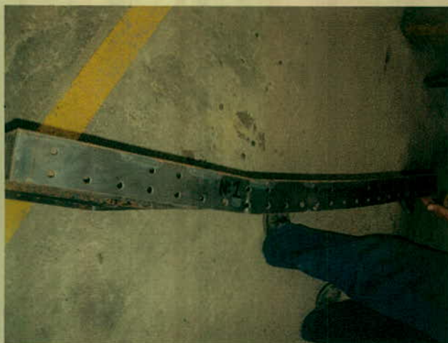
Foto No. 1 Esquema de montaje Carga simétrica en zona cercana a los tercios
