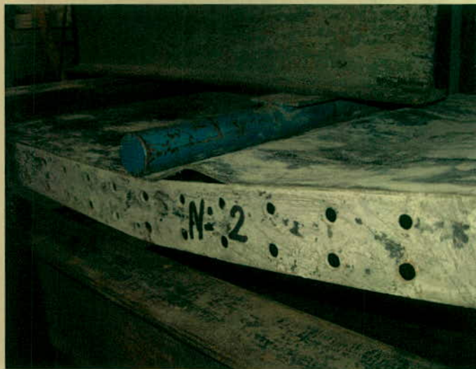
Foto No. 5 Falla muestra No. 2 en zona de aplicación de carga por rotura del cordón de soldadura de la lámina
