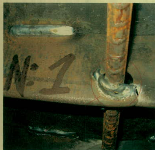
Foto No. 3 y 4 Falla de la formaleta No. 1, en la zona de rigidizadores longitudinales se reventó la soldadura y se agrandaron los agujeros
