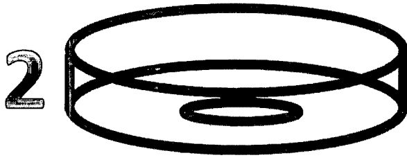
La Figura 2. Corresponde a la tapa inferior del filtro que sirve como estructura y presenta un orificio de flujo de combustible, donde se acopla a la base del filtro.
