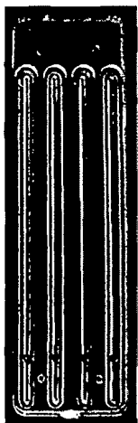
La microcubeta PTS contiene reactivos pre-dispensados, necesarios para ejecutar un análisis LAL.
