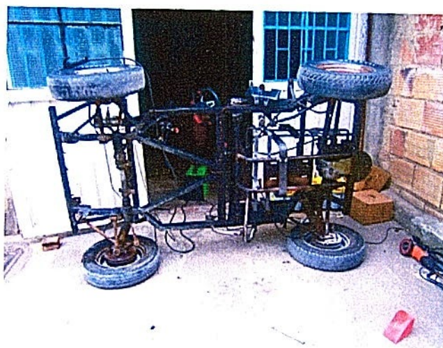
Fotografía 4. Soporte para las baterías-parte inferior del chasis
