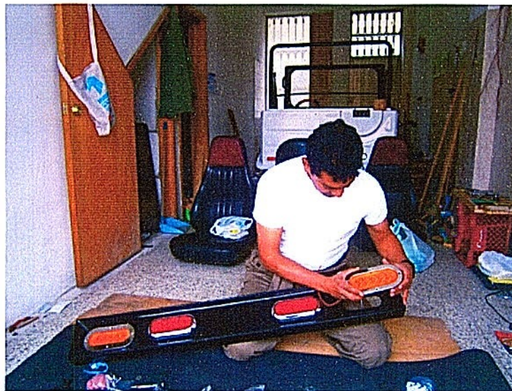
Fotografía 9. Instalación de direccionales y luces de parqueo.
