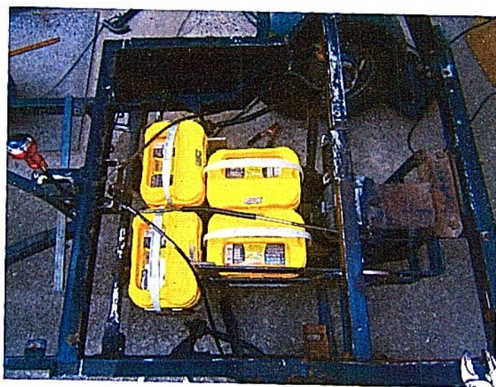
Fotografía 4. Soporte para las baterías-parte inferior del chasis
