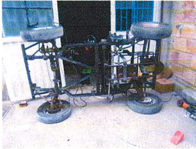
Fotografía 4. Soporte para las baterías-parte inferior del chasis
