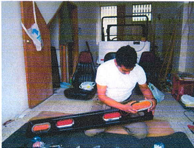
Fotografía 9. Instalación de direccionales y luces de parqueo.
