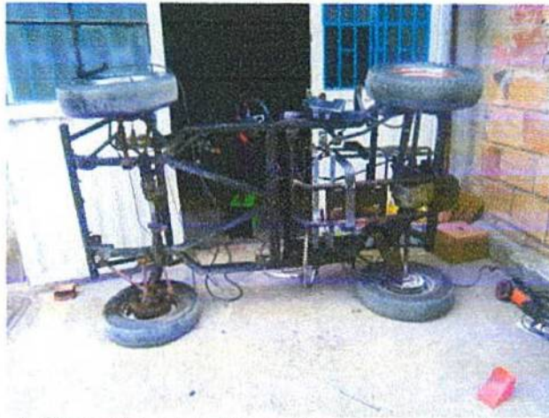
Fotografía 4. Soporte para las baterías-parte inferior del chasis
