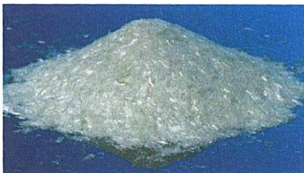
Figura 3. Fibra de vidrio cortada a 6.35 mm de longitud.
