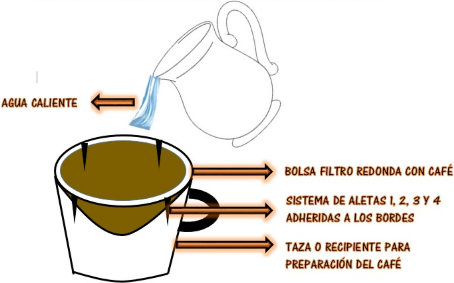
FIGURA 2: Modo de uso de la bolsa filtro redonda con sistema de aletas.
