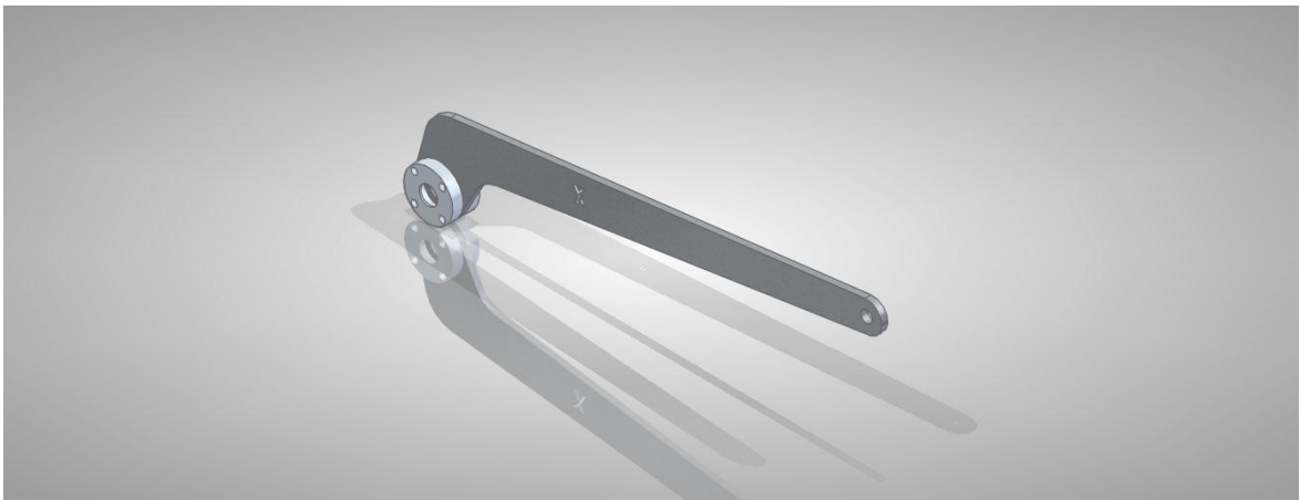
Figura 26. Diseño biela horizontal con doble rodamiento interno.
