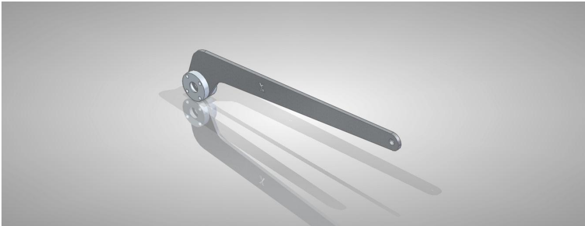
Figura 27. Diseño biela horizontal con doble rodamiento interno.
