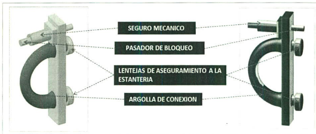
Figura 5. Descripción de las partes del CONECTOR
