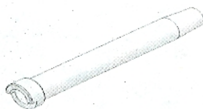
Figura 4. Muestra de la camisa guíao canal de trabajo.
