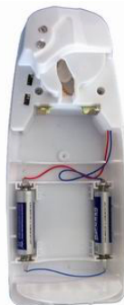
Detalle del ensamblaje los nuevos circuitos son instalados en el compartimiento del motor.
