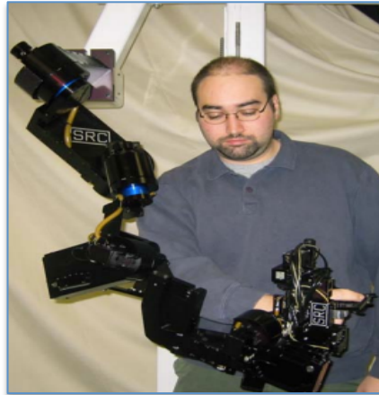
Figura 12. Exoesqueleto de Miembro Superior, Mistry et al. [12]
