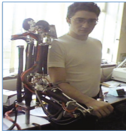
Figura 10. Exoesqueleto de Miembro Superior, Tsagarakis et al. [10]
