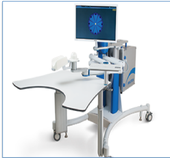
Figura 14. Exoesqueleto de Miembro Superior, Inmotion. [14]
