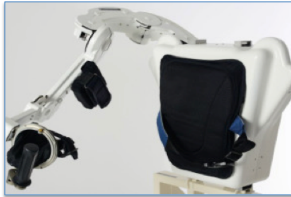
Figura 15. Exoesqueleto de Miembro Superior, Alex de Kinetek [15]
