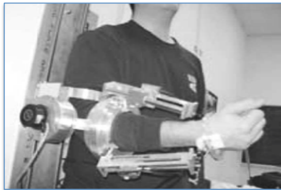
Figura 4. Exoesqueleto de Miembro Superior, Gupta et al. [4]
