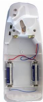
Detalle del ensamblaje los nuevos circuitos son instalados en el compartimiento del motor.
