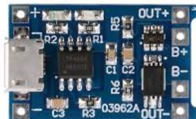
Módulo para la carga de las baterías
