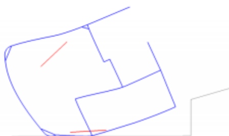
Fig. Deformación máxima del arco D 28 mm, NO intrusión a los 0.129 s.
