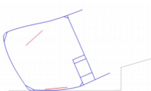
Fig. Deformación máxima del arco A 32mm, NO intrusión , a los 0.141 s.
