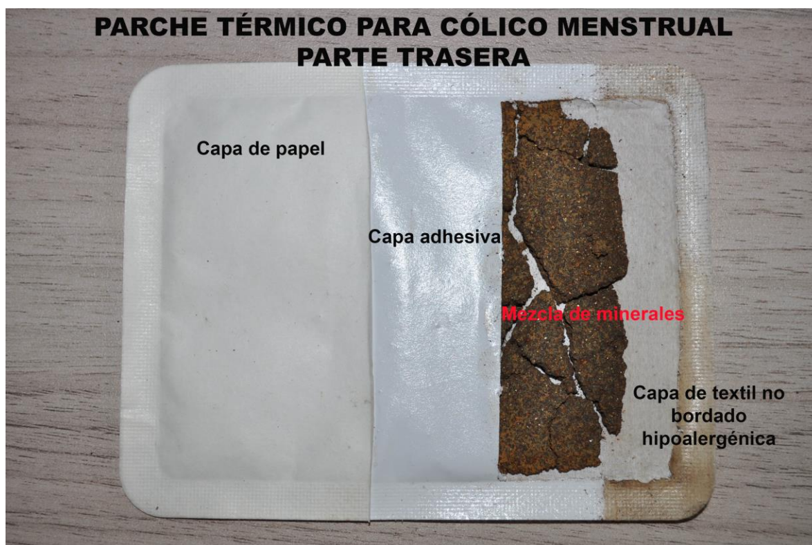
Fig. 2. D.- Vista parte trasera en corte por capas del parche N.1.
