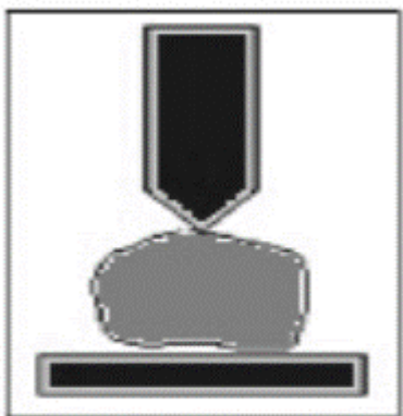
Figura 2.4 Fragmentación por corte (elaboración a partir de Vásconez, 2013)
