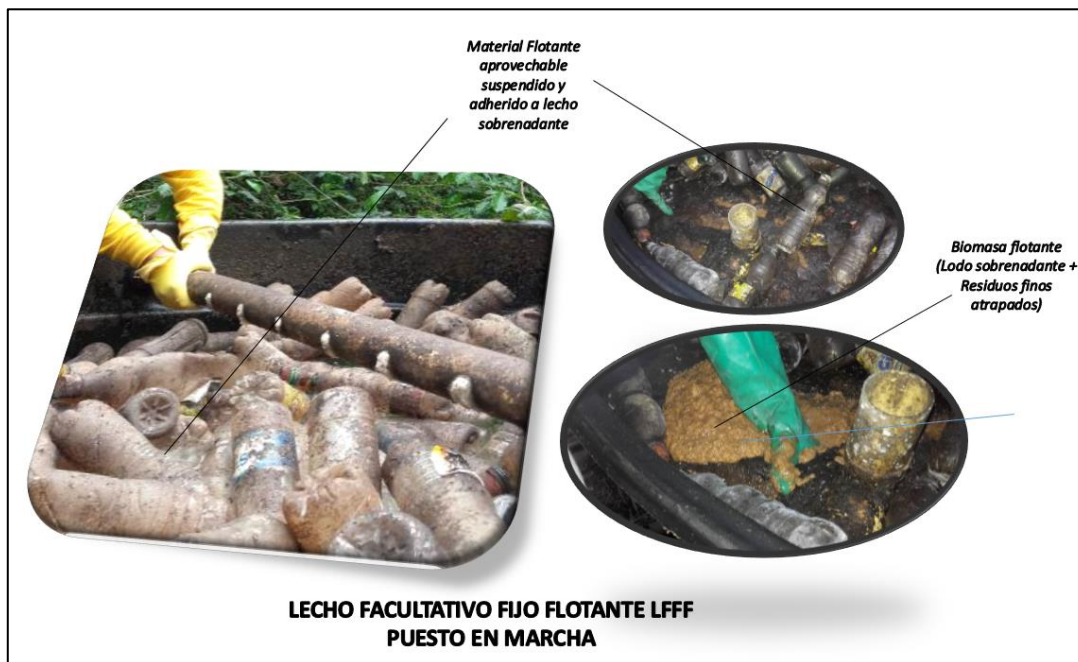
FIGURA N°16 –LECHO FACULTATIVO FIJO FLOTANTE LFFF “PUESTO EN MARCHA PARA TRATAMIENTO DE AGUAS RESIDUALES DEL LAVADO DEL CAFÉ”
