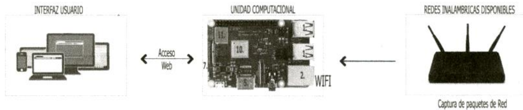
Imagen 5: Proceso de ejecución monitoreo wifi
