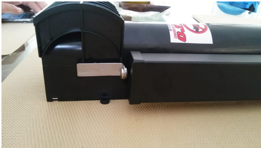
7. Vista de mecanismo magnético que indica que la trampa se cerró
