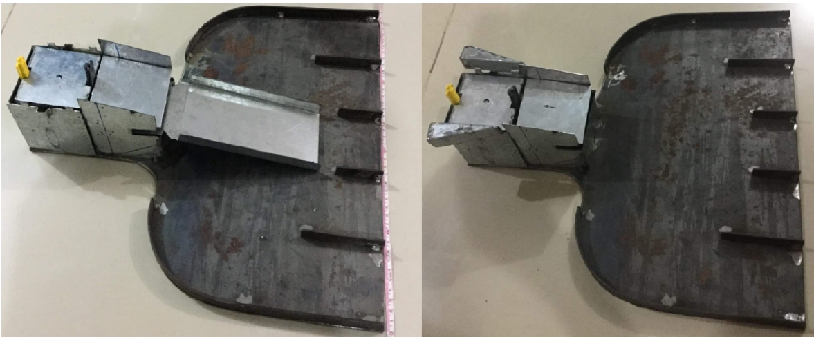
Dispositivo clasificador de huevos con bandeja de deslizamiento -imagen izquierda, sin bandeja de deslizamiento y con aditamentos en la esclusa de pesaje para alojar el emisor y sensor láser -imagen derecha (0)
