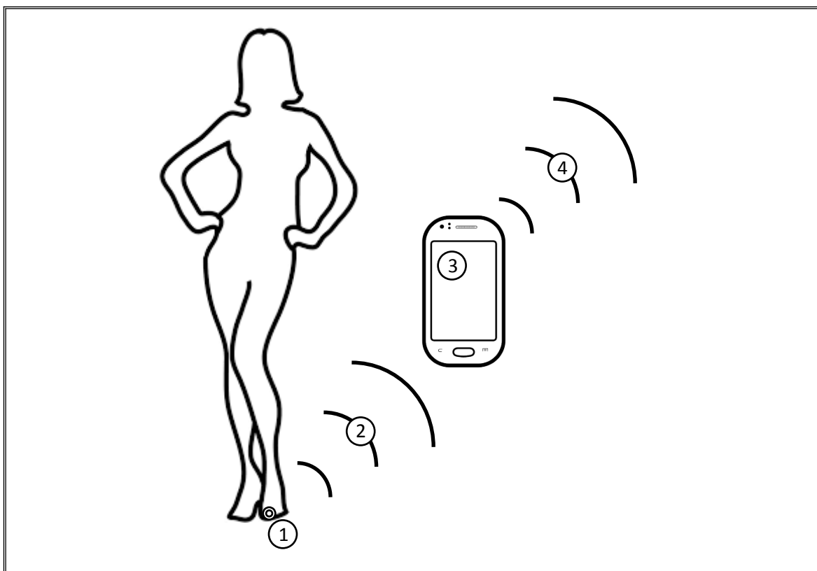
FIGURA 1: Componentes del sistema. 1) Anillo electrónico recargable para el dedo del pie, equipado con acelerómetro y conectividad Bluetooth. 2) Red inalámbrica personal Bluetooth 3) Aplicación del sistema instalada en el teléfono inteligente de la usuaria. 4) Internet.
