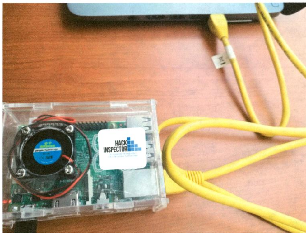
Imagen 21: Conexión HackInspector (unidad computacional configurada) a PC
