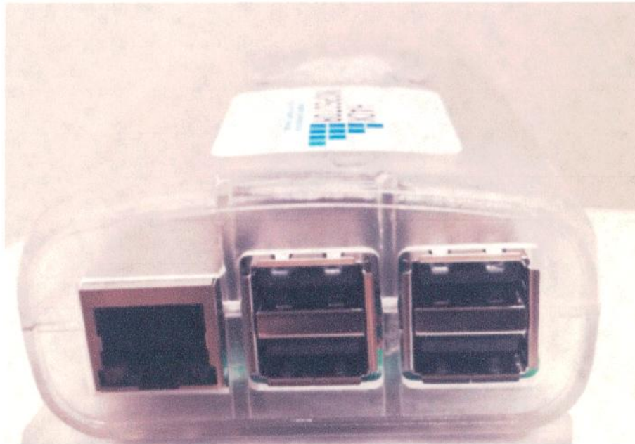
Imagen 22: Dispositivo frontal (Se evidencian puerto de red y puertos USB disponibles)
