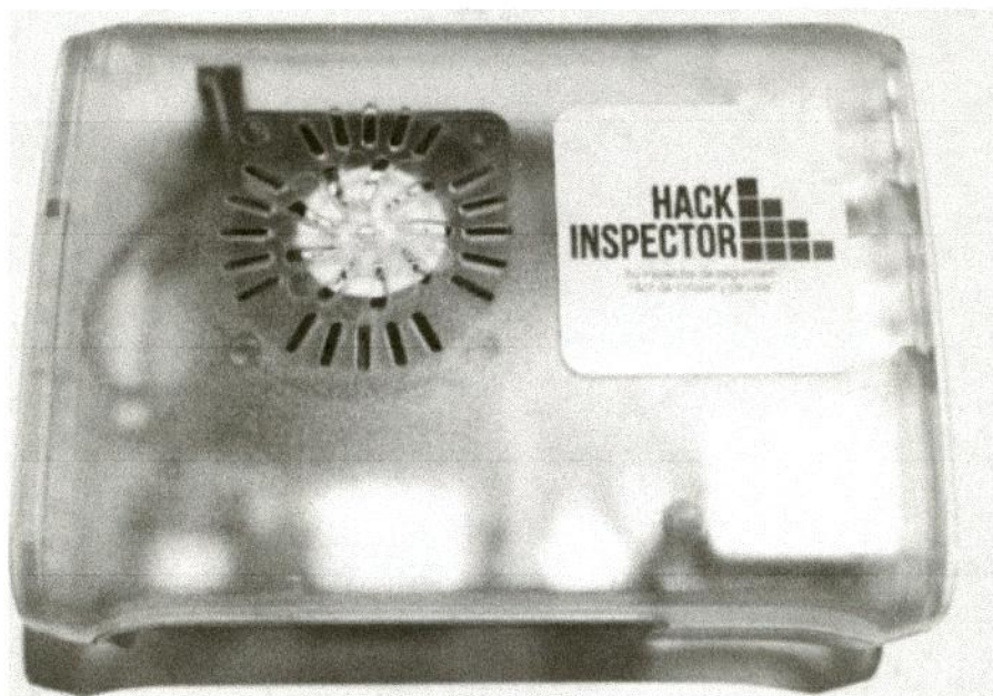
Imagen 25: Dispositivo vista superior (Se evidencia el ventilador para enfriamiento del dispositivo).
