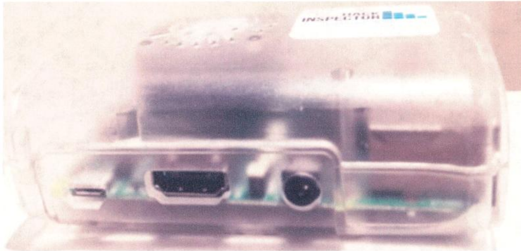
Imagen 24: Dispositivo lateral 2 (Se evidencia de izquierda a derecha puerto de alimentación, puerto HDM y, puerto de audio).
