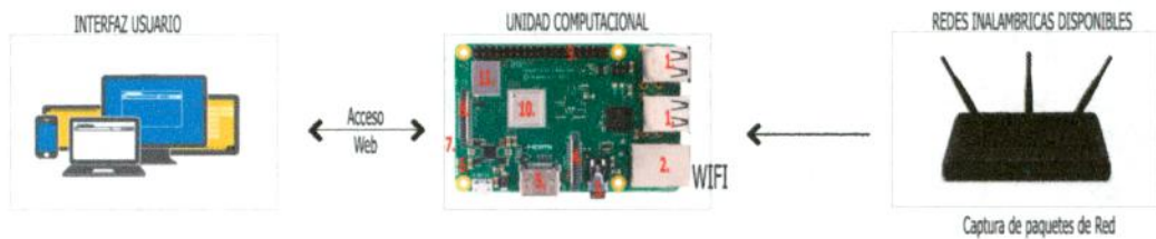
Imagen 5: Proceso de ejecución monitoreo wifi
