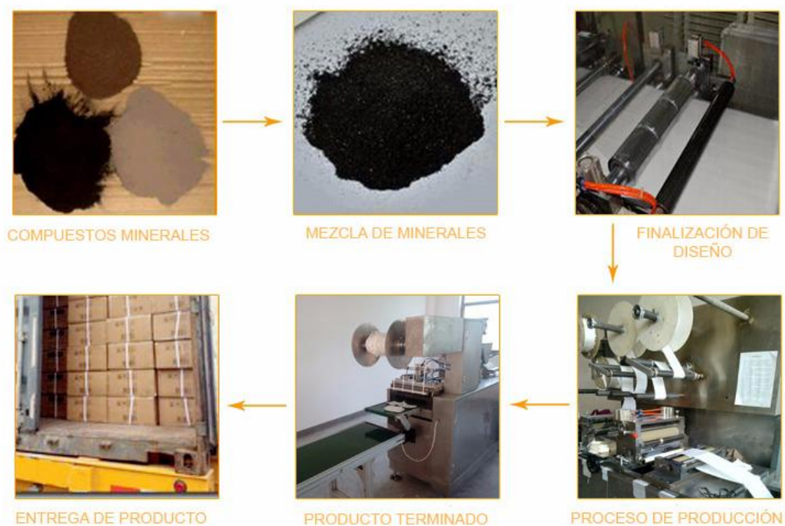
Fig. 1. B. – Proceso de Producción del Parche Térmico para Cólico Menstrual
