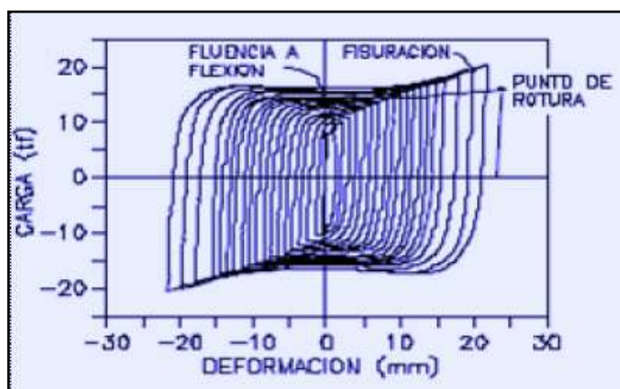
Fig. 1-2: Curva de histéresis de un dispositivo Honeycomb. [33]
