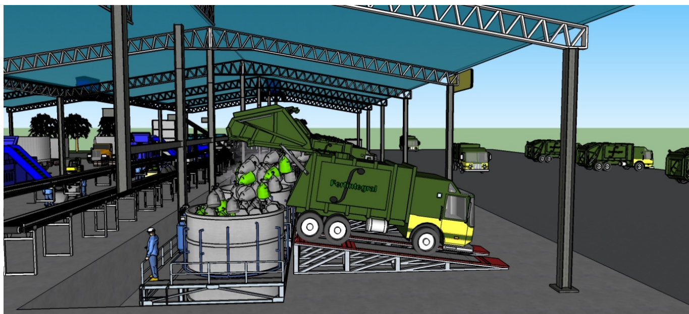
Figuras 2 y 3, Compactadores descargando su contenido.
