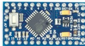
Fuente: Naylamp Mechatronics. Atmega328 Figura 7. Microcontrolador Atmega328
