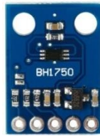
Fuente: Naylamp Mechatronics. Módulo BH1750 Figura 6. Fotorreceptor digital BH1750
