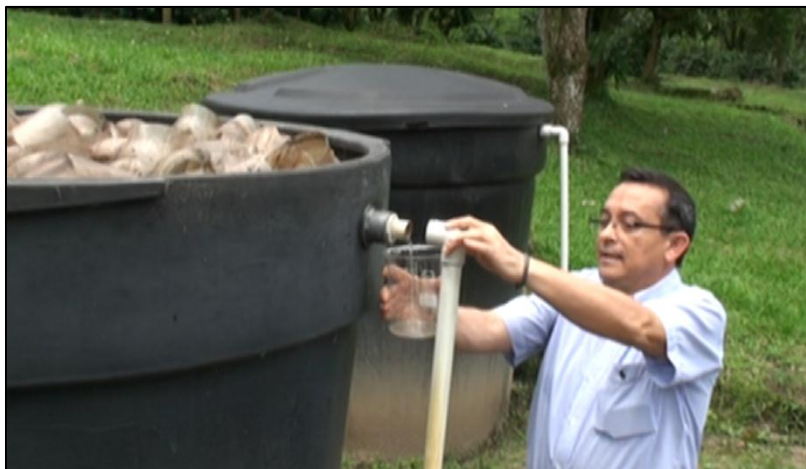
Figura N° 11 Método sencillo para toma de muestra efluente en RM del SMTA. Cenicafe Año 2010. (Boletín Técnico N°33. Video-Min 35:30)
