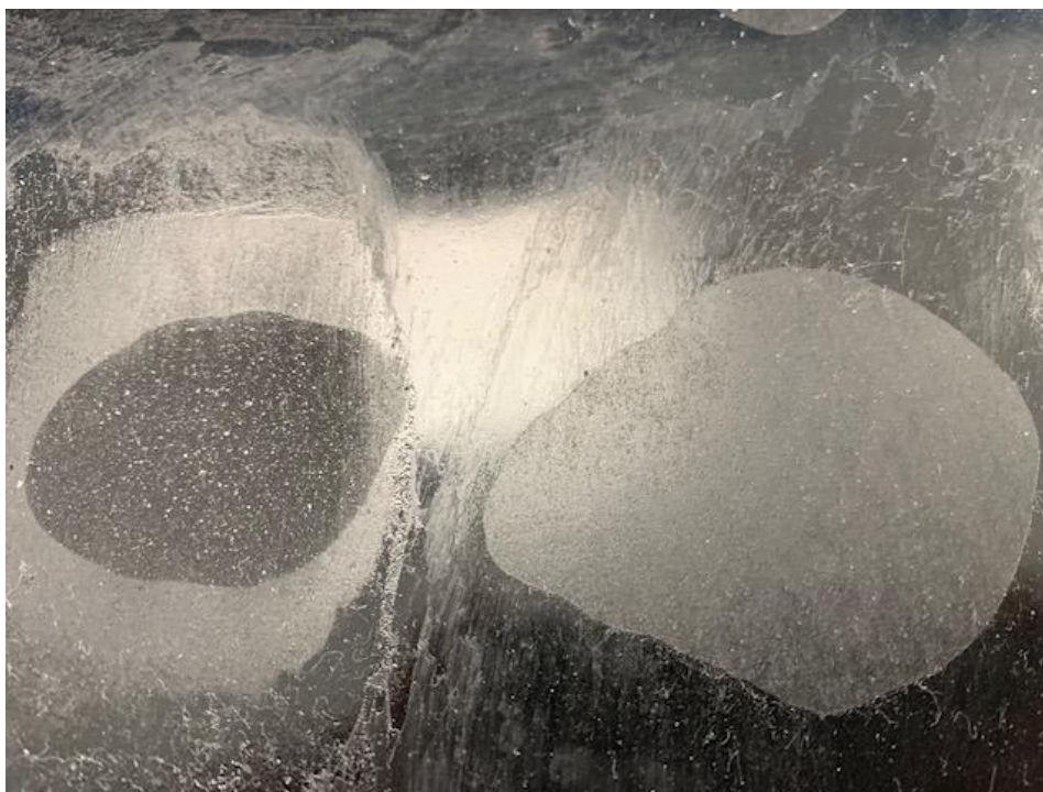
Figura 1. Remoción del acabado de piso Elysium (es decir, revestimiento de suelo de sacrificio antimicrobiano de la reivindicación 1). La baldosa se lavó después de 15 minutos de tiempo de permanencia. El removedor de pintura patentado (es decir, el removedor de pintura de D1) está a la izquierda, Elysium Stripper (es decir, el removedor como se indica en la reivindicación 9) a la derecha.
