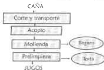
Figura 1. Diagrama de las etapas de producción de panela y miel desarrollados en frío.
