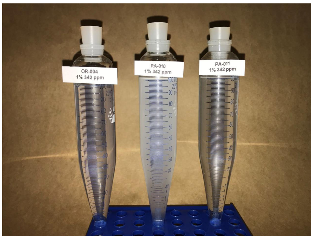
Imagen 11 - Comparación de nano emulsión NDS OR-004 de Oro Agri (izquierda) y emulsiones según los ejemplos 1 PA-011 (derecha) y ejemplo 4 PA-010 (centro) de emulsión al 1% en agua dura estándar (CIPAC D - 342 ppm) - Tiempo 2 horas
