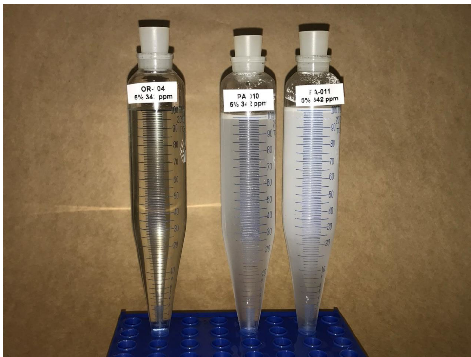
Imagen 15 - Comparación de nano emulsión NDS OR-004 de Oro Agri (izquierda) y emulsiones según los ejemplos 1 PA-011 (derecha) y ejemplo 4 PA-010 (centro) de emulsión al 1% en agua dura estándar (CIPAC D - 342 ppm) - Tiempo 2 horas
