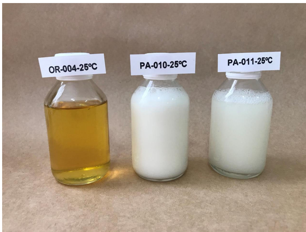
Imagen 3 - Comparación del NDS OR-004 (izquierda) de Oro Agri y los productos elaborados según el ejemplo 1 - PA-011 (derecha) y el ejemplo 4 PA-010 (derecha) de Wooster. Después de 14 días a 25°C (después de agitar)
