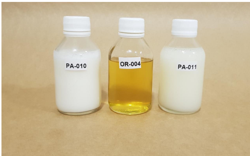
Imagen 1 - Comparación del NDS OR-004 (izquierda) de Oro Agri y los productos elaborados según el ejemplo 1 - PA-011 (derecha) y el ejemplo 4 PA-010 (derecha) de Wooster. Tiempo cero a 25oC.
