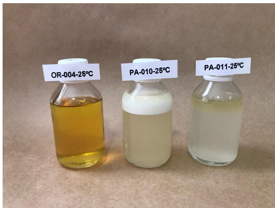
Imagen 2 - Comparación del NDS OR-004 (izquierda) de Oro Agri y los productos elaborados según el ejemplo 1 - PA-011 (derecha) y el ejemplo 4 PA-010 (derecha) de Wooster. Después de 14 días a 25oC (sin agitar)
