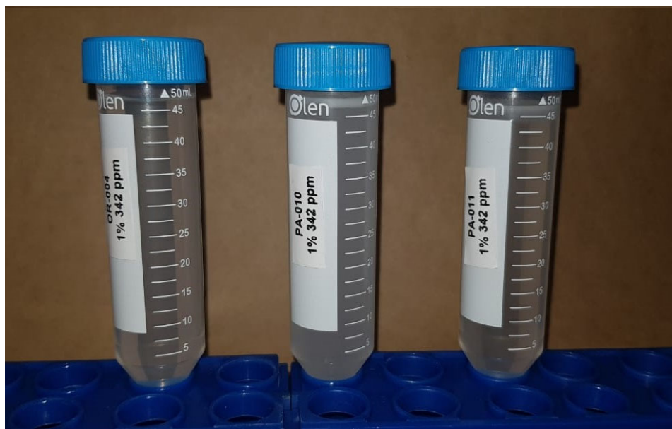
Imagen 19 - Comparación de nano emulsión NDS OR-004 de Oro Agri (izquierda) y emulsiones según los ejemplos 1 PA-011 (derecha) y ejemplo 4 PA-010 (centro) de emulsión al 1% en agua dura estándar (CIPAC D - 342 ppm) - Tiempo 48 horas
