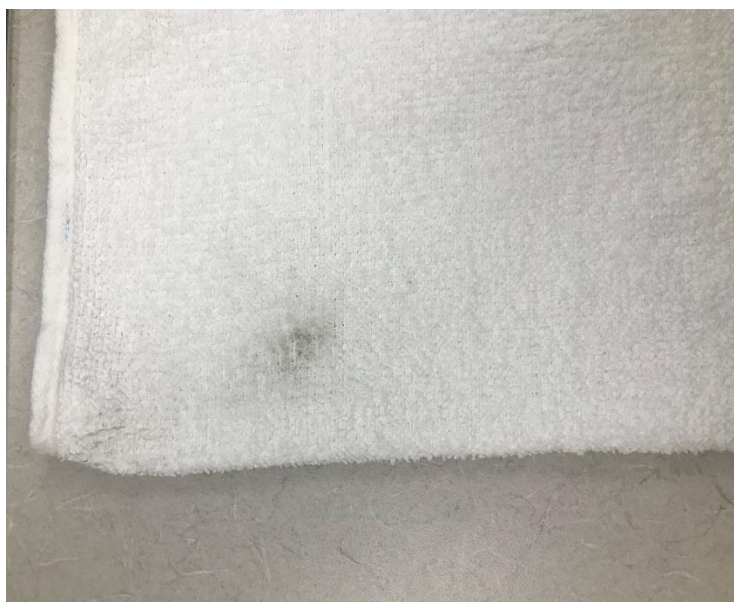
Figura 3. Toalla blanca después de que Elysium Stripper se lavó y se secó del VCT.
