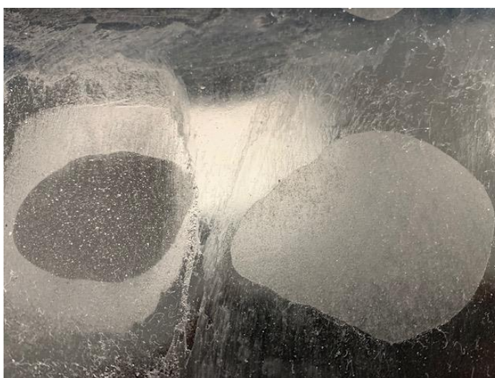
Figura 1. Remoción del acabado de piso Elysium (es decir, revestimiento de suelo de sacrificio antimicrobiano de la reivindicación 1). La baldosa se lavó después de 15 minutos de tiempo de permanencia. El removedor de pintura patentado está a la izquierda, Elysium Stripper (es decir, el removedor como se indica en la reivindicación 9) a la derecha.
