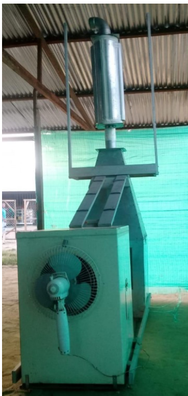
Fotografía 1. Prototipo de laboratorio de pruebas del filtro de tejido de lana de acero
