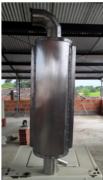
Fotografía 2. Vista frontal del filtro de tejido de lana de acero
