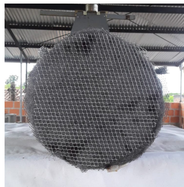
Fotografía 5. Vista superior de la malla envolviendo el tejido de lana de acero
