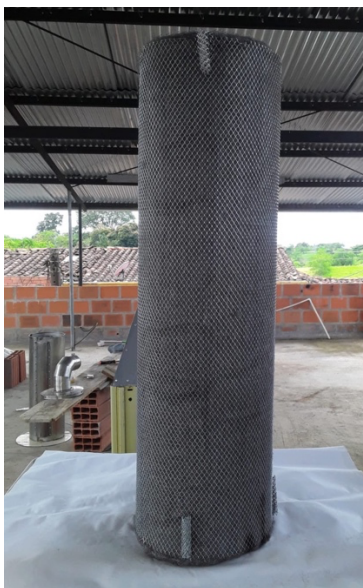
Fotografía 3. Vista frontal de la malla que envuelve el tejido de lana de acero
