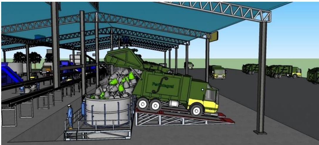
Figura 3 - Vehículos Compactadores Descargando su Contenido en Termo-tubos
