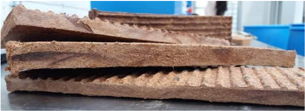
Probetas usando tamaños de mallas No. 40 - 60. No se evidencian espacios vacíos.
