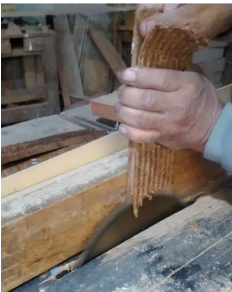
Figura: Corte realizado a una probeta para medir elasticidad
