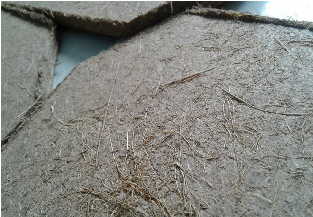
Condiciones no estéticas del material por uso de fibras largas
