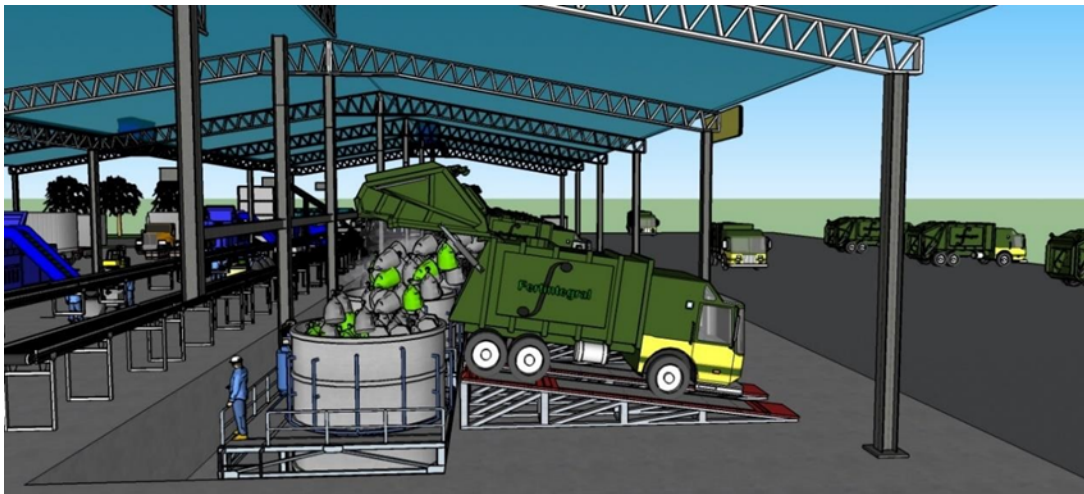
Figura 2 - Vehículos Compactadores Descargando su Contenido en Termo-tubos
