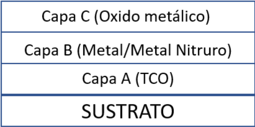
Estructura de D4
