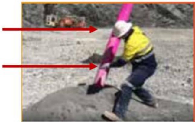
Inserción de la hoja en el barreno usando aberturas separadas longitudinalmente
