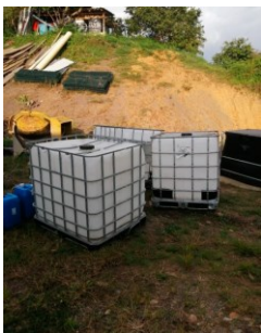
Foto de los tanques de plástico de los biodigestores
