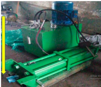
Válvula de succión de gas de la bolsa de lona negra “PVC800”
