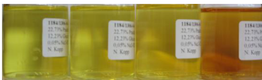
Figura 4: Soluciones con EDTA de sodio al 0,05% a 5, 25, 40, 60°C después de 1 mes de almacenamiento.
