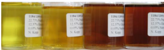
Figura 2: Soluciones con ascorbato de sodio al 0,15% a 5, 25, 40, 60°C después de 1 mes de almacenamiento.
