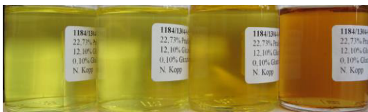
Figura 3: Soluciones con 0,15% de glutación a 5, 25, 40, 60°C después de 1 mes de almacenamiento.
