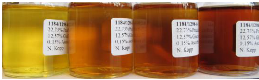
Figura 1: Soluciones con ácido ascórbico al 0,15% a 5, 25, 40, 60°C después de 1 mes de almacenamiento.
