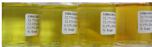
Figura 6: Soluciones con ácido cítrico al 0,15% a 5, 25, 40, 60°C después de 1 mes de almacenamiento.
