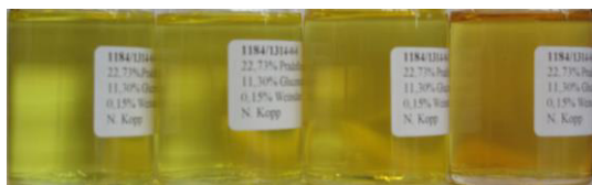
Figura 5: Soluciones con ácido tartárico al 0,15% a 5, 25, 40, 60°C después de 1 mes de almacenamiento.
