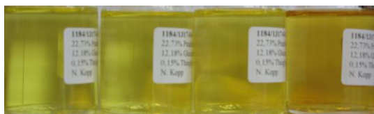
Figura 7: Soluciones con tioglicerol al 0,15% a 5, 25, 40, 60°C después de 1 mes de almacenamiento.
