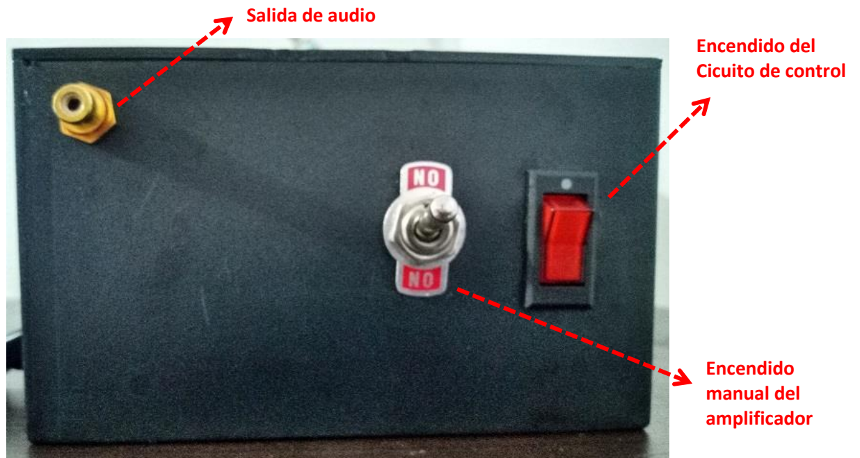
Figura 6. Conexiones externas del circuito de control
