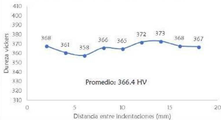
Perfil de Dureza muestra con tratamiento
