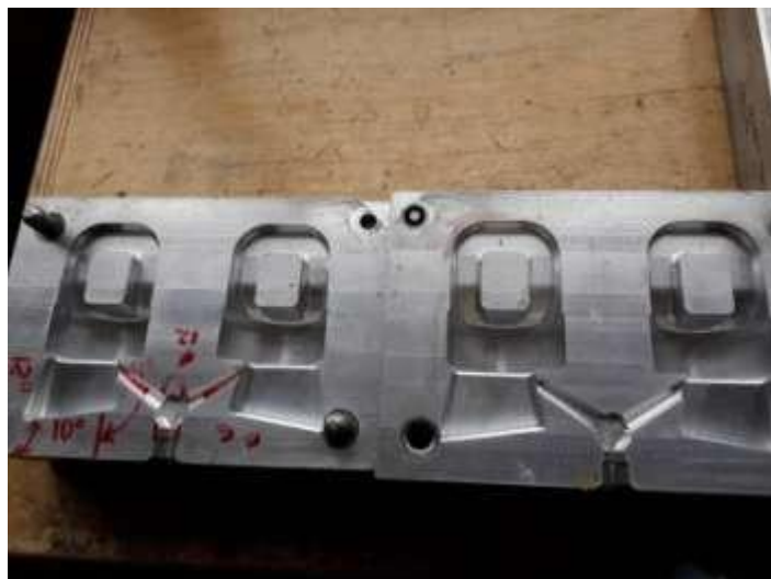
Molde en Aluminio – Pieza Marcada #ABX / Dimensionalmente cumpliendo con la norma MS3314 Ver Reporte Dimensional 2.2 -31 del 30/05/2018 – Columna No.3
