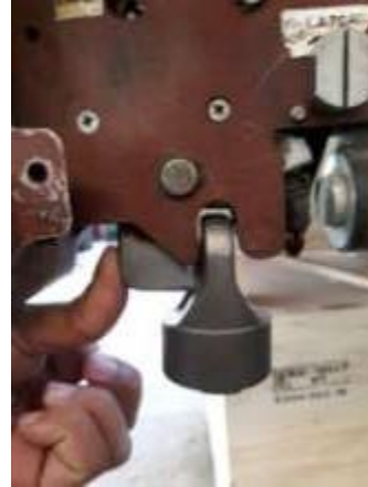
Simulación Perno Microfundido Alternativa B en Bomb Racks
