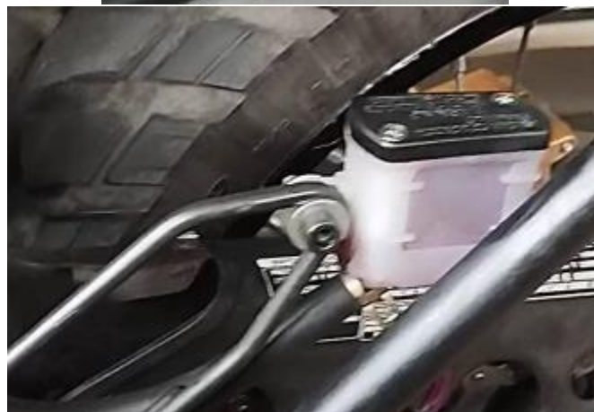
Deposito montado en la moto
