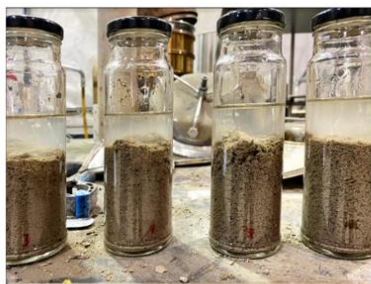
Muestra de MFT con TNS antes de la centrifugación (Iniciado el proceso de sedimentación) Diferentes dosis de TNS
