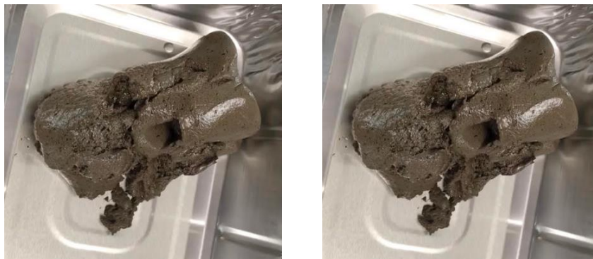
Figura 2. Muestras de MFT recuperadas del recipiente de centrifugación después de ser tratadas con TNS.
