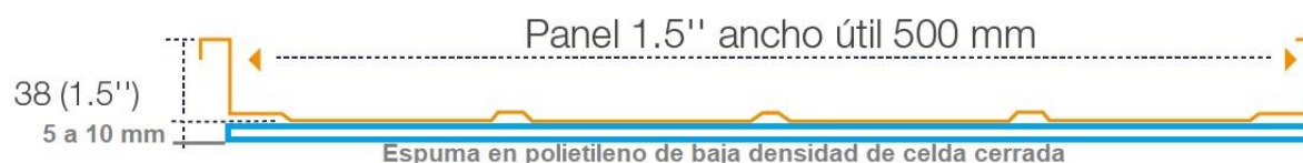
FIGURA 1: Muestra el corte trasversal de la teja Traslapolsofoam
