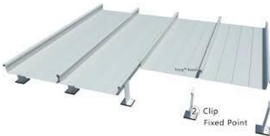
FIGURA 4: Muestra el esquema de fijación de la teja Traslapolsofoam
